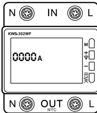
4. Отключение питания по таймеру. Нажмите еще раз M, чтобы отобразилось 000:00T. Нажмите +- для регулировки (шаг в 30 минут). Нажмите один раз, чтобы добавить или вычесть 1 В, удерживайте, чтобы быстро добавить или вычесть, значение по умолчанию 0.
