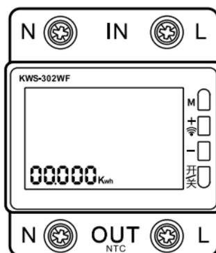
6. Настройка защиты от перегруза питания. Нажмите еще раз M, чтобы отобразилось 0 Вт. Нажмите +/- для регулировки (шаг в 10 Вт). Нажмите один раз, чтобы добавить или вычесть 0,1 Вт, удерживайте, чтобы быстро добавить или вычесть, значение по умолчанию 0.
